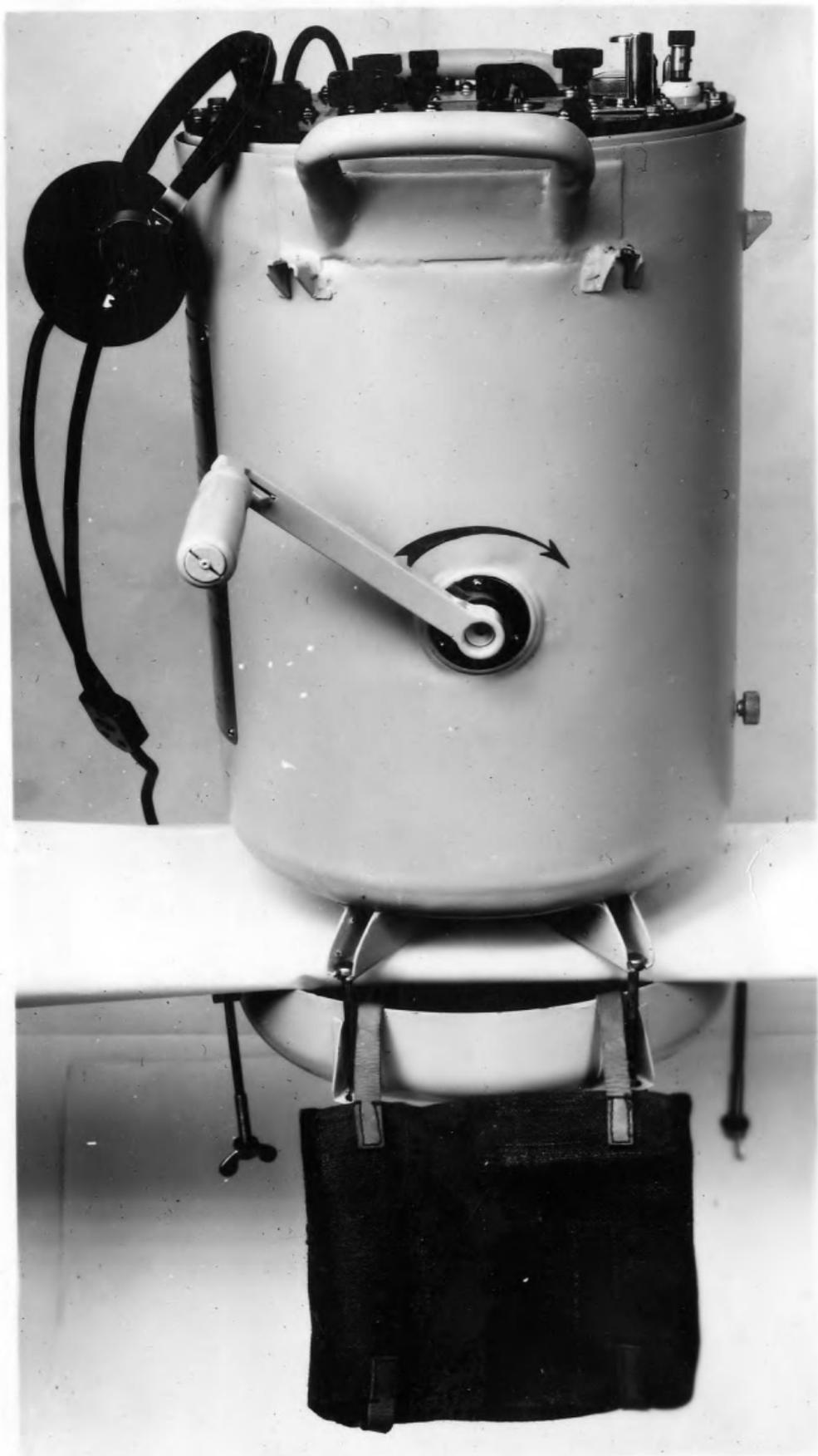
в воду с борта корабля. Радиостанция имеет положительную пловучесть и может быть после спуска или сбрасывания извлечена из воды в шлюпку. К кожуху радиостанции приделаны две ручки, с помощью которых радиостанцию можно переносить или вынимать из воды.
